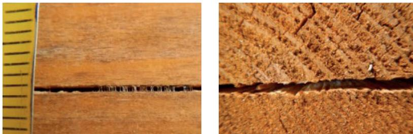
Figura 3.2) A sinistra: incollaggio insufficiente a causa di una non corretta applicazione o reticolazione dell'adesivo in stabilimento; a destra: incollaggio non più efficiente causa le variazioni di umidità del materiale
